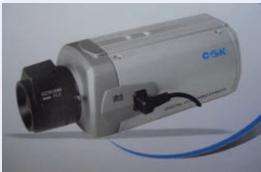
شکل ۳-۲۲ اتصال کابل لنز اتوایریز به دوربین
