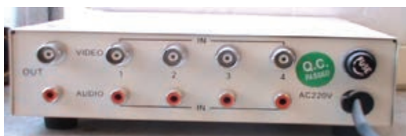
شکل ۶۰-۳ قسمت‌های مختلف پشت سویچر
