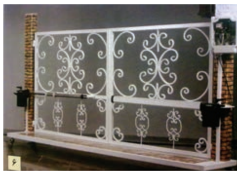
شکل ۴-۴۹ یک نمونه در اتوماتیک لولایی
