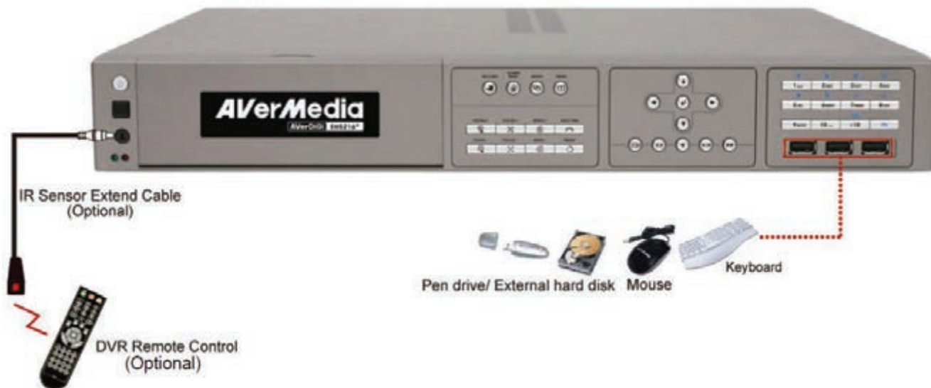
شکل ۳-۷۱ محل اتصال تجهیزات جانبی به دستگاه ضبط کننده
