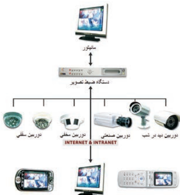
شکل ۳-۷۹ دیاگرام کلی اتصالات یک نمونه سیستم دوربین مدار بسته
