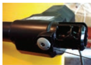
خلاص کن درب اتوماتیک لولایی که توسط آچار مخصوص (کلن) باز میشود
