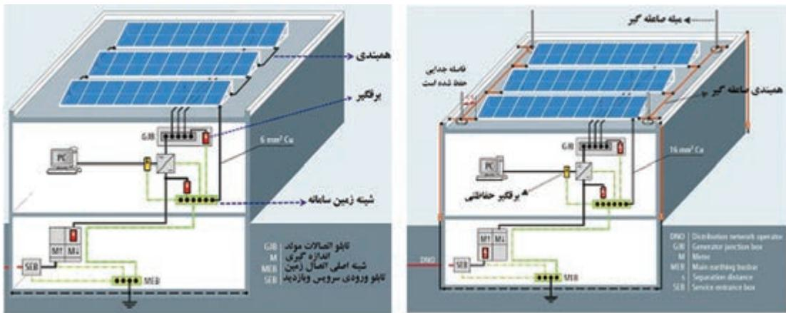
شکل ۳۲- اتصال برق گیر و همبندی با اتصال زمین
