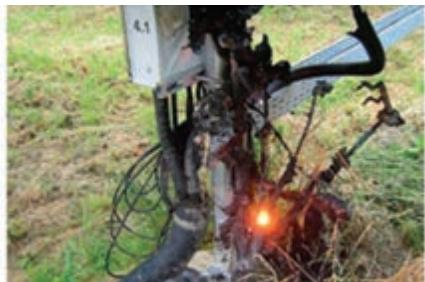
شکل ۳۶- سامانه فتوولتاییک بدون اتصال زمین که منجر به آتش‌سوزی شده است.
