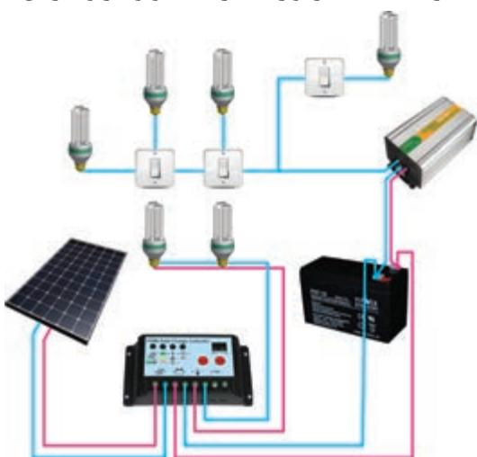
شکل ۵۰- مدار کار عملی ۳
