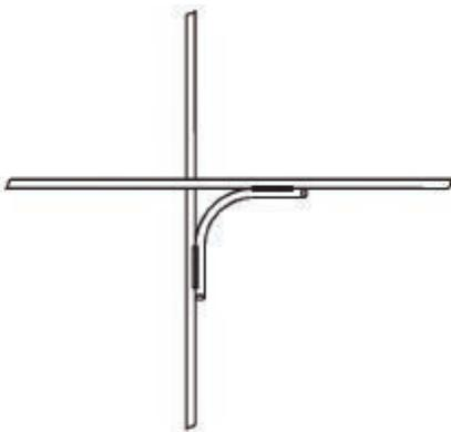
شکل ۱۹- جوشکاری میلگردها در یک تقاطع چهارراه
