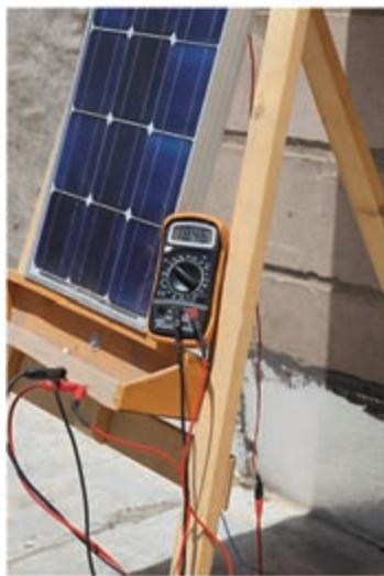
شکل ۱۵-۱ اندازه‌گیری ولتاژ بی‌باری
