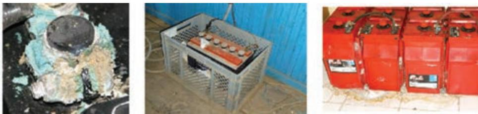
شکل ۲۱- سولفاته و نشتی باتری
