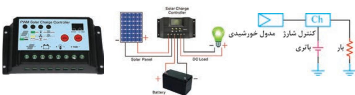
شکل ۳۳- یک نمونه کنترل کننده شارژ باتری
