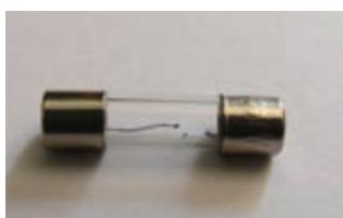
شکل ۴۹- فیوز سر راه باتری سوخته است.
