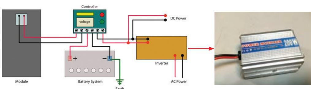
شکل ۳۹ - یک اینورتر مبدل ۱۲ ولت DC به ۲۰۰ ولت AC با توان ۲۰۰ وات و فرکانس ۵۰ هرتز
