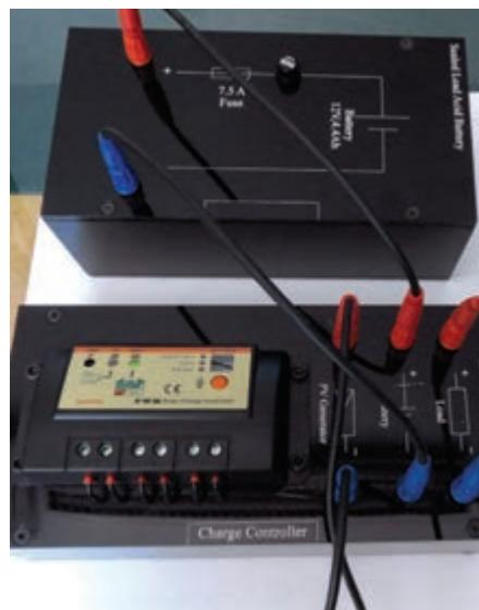
شکل ۳۷ - اتصال کنترل کننده شارژ به مدول
