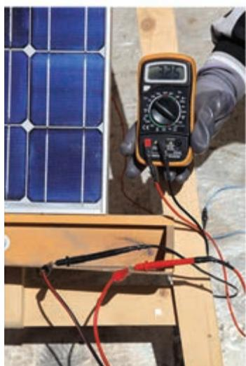
شکل ۱۵-۲ اندازه‌گیری جریان اتصال کوتاه
