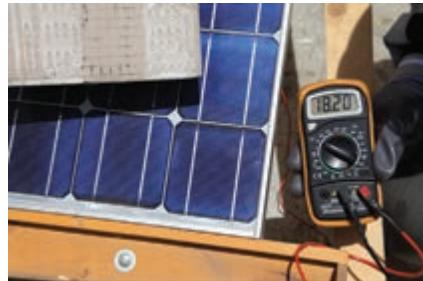
شکل ۷-الف - اثر سایه بر ولتاژ بی‌باری
