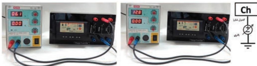
شکل ۱۸- تست کنترل شارژ
