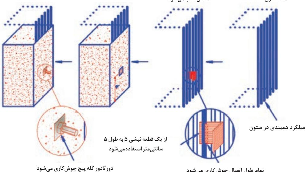
شکل ۲۹- مراحل کامل قطعه اتصال همبندی به زمین
