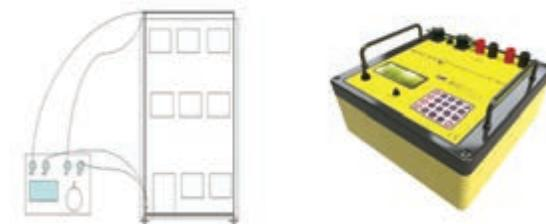
شکل ۳۰- دستگاه چهار سیمه و طریقه اندازه‌گیری
