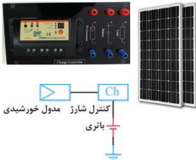
شکل ۳۵- اتصال باتری به مدول خورشیدی و کنترل شارژ
