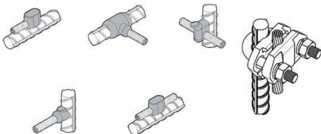
اگر هادی مسی را به عنوان هادی همبند انتخاب می کنید هادی مسی باید دارای مقطع حداقل ۱۶ میلی متر مربع بوده و در هر فاصله ۶ متر با استفاده از جوش احتراقی یا بست پیچی مطابق تصاویر داده شده به میل گرد متصل شود.
