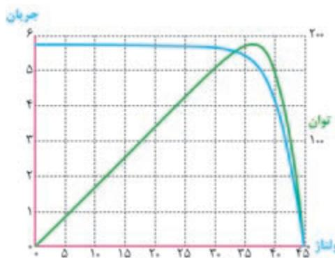
شکل ۱۵- منحنی ولتاژ - جریان و توان یک مدول
