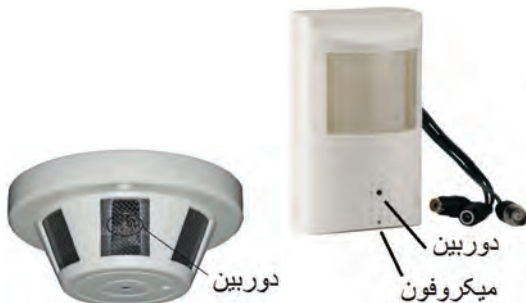
شکل ۳-۴ دوربین‌های مخفی در داخل آشکارسازها
