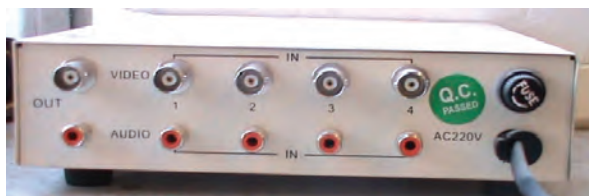
شکل ۶۰-۳ قسمت‌های مختلف پشت سویچر
